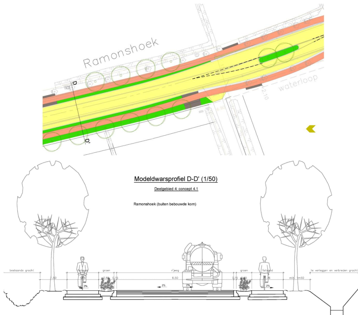
Figuur 31. Infiltratiestroken in Ramonshoek in Wachtebeke: bovenaanzicht (boven) en dwarsdoorsnede (onder). Bron: Aquafin.
