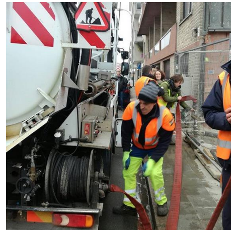
Figuur 30. Hergebruik van bemalingswater: via opslagtanks in Nevele (links, bron: HLN) en vullen van veegwagens in Brussel (rechts, bron: OpenSource Brussels).
