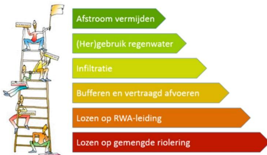
Figuur 28. Ladder van Lansink, toegepast op hemelwaterbeheer (CIW, 2017).
